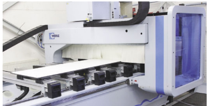
/ Auf zwei CNC-Bearbeitungszentren wird der anspruchsvolle Werkstoff im Zweischichtbetrieb präzise in Form gebracht und komplettbearbeitet.
